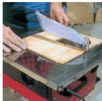
**3. La machine électrique à tronçonner le carrelage est nécessaire pour les carreaux très durs.**
