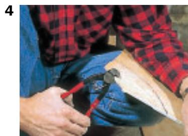
**4. Avec une pince à rogner de type "bec de perroquet", casser par petits morceaux de 2 à 3 mm la partie à éliminer, jusqu'au tracé.**
